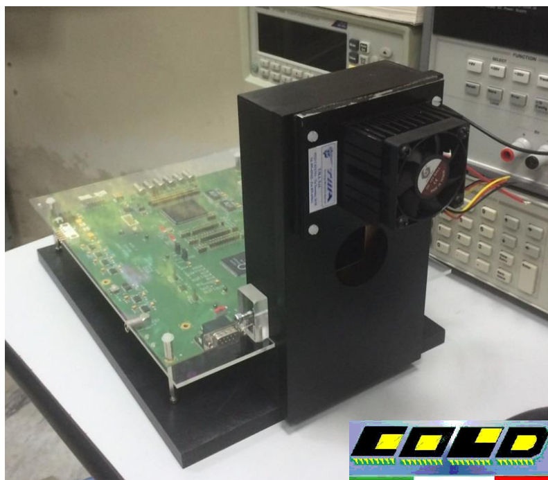
Figura 4. Set-up che include l'evaluation board CITIROC press oil laboratorio COLD.
