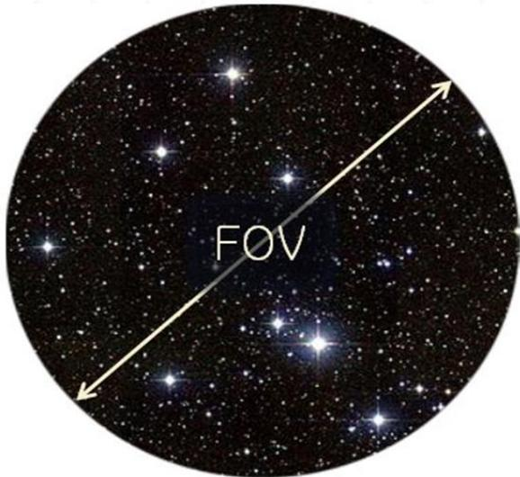
La distanza tra i bordi opposti dell'immagine fornita da un telescopio è il suo "Campo Visivo" (FoV). Anche il FoV non è una caratteristica di un telescopio, in quanto dipende dal FoV dell'oculare utilizzato e dal corrispondente ingrandimento:
